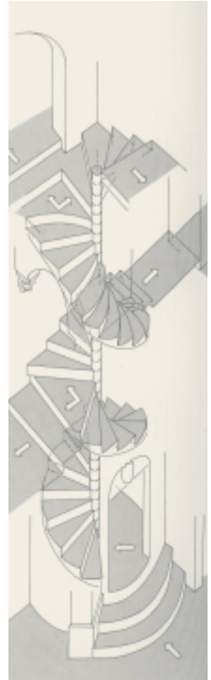
Abb. 8: Worb, Schloss, schematische Isometrie der 1472 erbauten, Bergfried und Palas mit ihren unterschiedlichen Niveaus gemeinsam erschliessenden Treppe.
